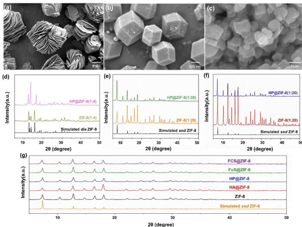
**Fig. 2.** SEM images of HP@ZIF-8 (a)  $M(OAc^-)$ : L = 1:4; (b)  $M(OAc^-)$ : L = 1:20; (c)  $M(NO_3^-)$ : L = 1:20. XRD patterns of HP@ZIF-8 (d)  $M(OAc^-)$ : L = 1:4; (e)  $M(OAc^-)$ : L = 1:20; (f)  $M(NO_3^-)$ : L = 1:20. (g) XRD patterns of ZIF-8, HA@ZIF-8, HP@ZIF-8, FuS@ZIF-8 and FCS@ZIF-8.
